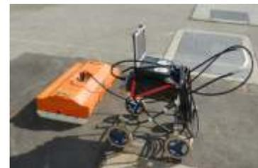
Géoradar équipé d'une antenne
